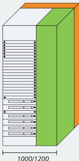
Втычной конструктив отходящих фидеров представляет собой низкоценную альтернативу выкатному конструктиву. Благодаря применению на стороне ввода втычных контактов и их компактному дизайну модули могут быть легко и быстро заменены без отключения питания установки. С втычным дизайном, SIVACON предлагает высокую степень экономической эффективности, безопасности и гибкости.
