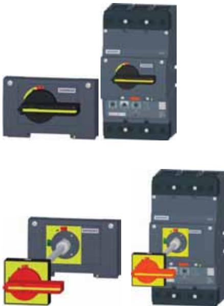
Поворотный привод позволяет управлять автоматическим выключателем с помощью вращения рычага, например, для того, чтобы включить или отключить машину. Модульная концепция приводов дает возможность простого монтажа на коммутирующий блок (и в качестве навесного элемента) после снятия крышки с отсека вспомогательных устройств. Стационарный электродвигатель можно опломбировать. Привод и его принадлежности заказываются отдельно (см. стр. 4/6).
