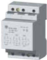
Три уровня задержки устанавливаются схемным соединением. Модуль задержки 3VT9 000-1UX00 используется только для расцепителя с  $U_e = 230$  В AC, который активирует задержку размыкания автоматического выключателя 3VT модулем отключения минимального напряжения.
