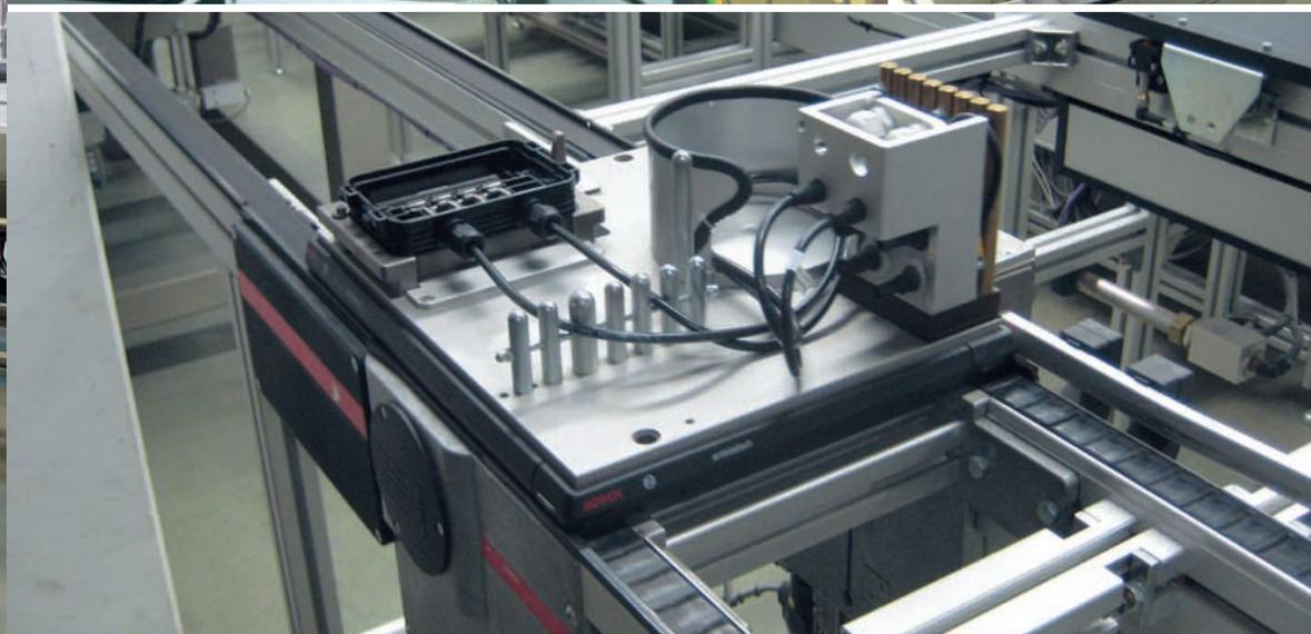
Eine speziell entwickelte Drehmoment-Verschraubstation sorgt mit der SPS-Regelstrecke für das richtige Anzugsmoment und Einhaltung von Schutzart und Zugentlastung der Leitungseinführungen.
