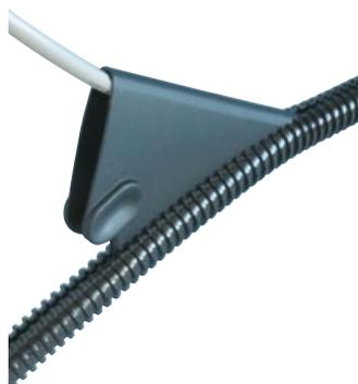
Einzugswerkzeug aus Polyamid 6 in Farbe schwarz. Verwendung zum Einziehen von Kabeln in Co-flex-Wellrohre und in geschlitzte Rohre. Ausführung NW 7,5 – NW 34.
