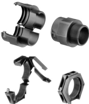
Teilbare Verschraubung und teilbare Gegenmutter mit Pg-Gewinde aus Polyamid 6 in Farbe schwarz, Schutzart IP43, halogenfrei und nicht flammenausbreitend.
