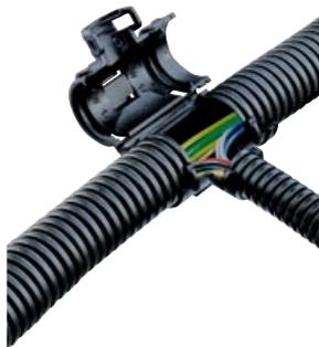
Verbindungsstücke aus Polyamid 6 für die Verbindung von drei parallelgewellten Kunststoffwellschläuchen, halogenfrei und nicht flammenausbreitend, in Farbe schwarz. Passend für die Kunststoffwellschläuche FFMYD PA6, FFMYD-L, FFHY, FFTYL-BS, FFTYL-V und FFPYL-MOD-BS.
