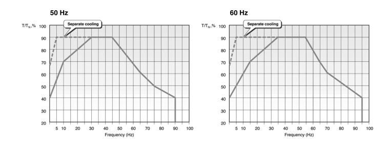
Guideline loadability curves with other voltage source PWM-type converters Общие кривые допустимой нагрузки при работе с другими преобразователями частоты с ШИМ-регулированием
