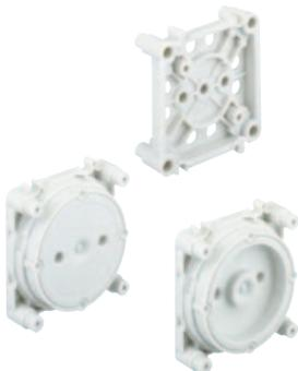
**Blindsockel**, Basis zur Abstützung von IBT-Dosen und Kästen bei Gegenschalung in Verbindung mit Stützholmen, kombinierbar durch Rastverbindung. Bei Montage der Blindsockel mit Nagel-, Magnet-, Klebe-Technik ist ein späteres Verputzen der Befestigungsstellen erforderlich.
