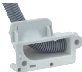
**Universalauslass** für Betoneinbau, zur einfachen Rohrübergabe im Wand- und Deckenbereich oder zur Weiterführung von Rohren unter dem Estrich. Einführungen für Rohre bis M25. Geeignet für Klebefestigung und Gegenschalung
