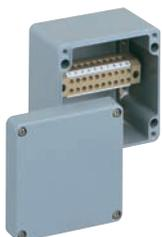
Reihenklemmgehäuse in kompakter Bauform, pulverlackbeschichtet silbergrau RAL 7001, bestückt mit 10-poliger Blockklemme 0,2-4 mm<sup>2</sup> (Schraubanschluss)
