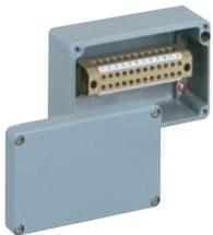
Reihenklemmgehäuse in kompakter Bauform - Industrie Qualität - Aluminium, pulverlackbeschichtet silbergrau RAL 7001, bestückt mit 12-poliger Blockklemme 0,2-4 mm<sup>2</sup> (Schraubanschluss)
