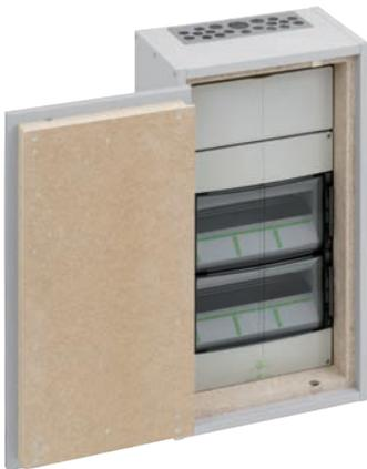
WKE AK-Kleinverteiler VDE zertifiziert nach EN 61 439 Teil 2, VDE geprüft und zertifiziert unter besonderen Betriebsbedingungen nach EN 61 439-2 Abs. 7.2, Geprüft nach DIN 4102 Teil 2 durch MPA Dresden., Brandlastdämmung F90 (in Anlehnung I90) zum Schutz des Flucht- und Rettungswegs gemäß MLAR 2005, Funktionserhalt F90 (in Anlehnung E90) zum Schutz der Elektrischen Einbauten gemäß MLAR 2005, Individuell bestückbar mit typgeprüften Betriebsmitteln
