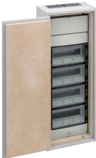
WKE AK-Kleinverteiler VDE zertifiziert nach EN 61 439 Teil 2, VDE geprüft und zertifiziert unter besonderen Betriebsbedingungen nach EN 61 439-2 Abs. 7.2, Geprüft nach DIN 4102 Teil 2 durch MPA Dresden., Brandlastdämmung F90 (in Anlehnung I90) zum Schutz des Flucht- und Rettungswegs gemäß MLAR 2005, Funktionserhalt F90 (in Anlehnung E90) zum Schutz der Elektrischen Einbauten gemäß MLAR 2005, Individuell bestückbar mit typgeprüften Betriebsmitteln
