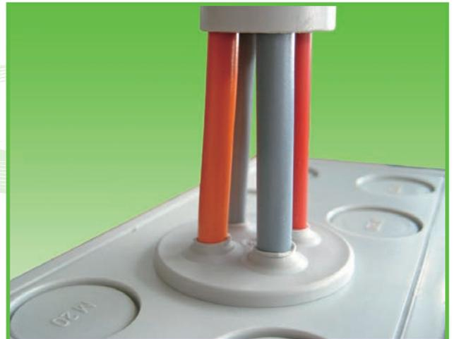
Der 4-fach Doppelmembranstutzen (Schutzart IP66) bietet dank doppelter Abdichtung mit zwei Dichtungsmembranen eine sichere Kabeleinführung für bis zu vier Leitungen.
