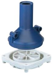
Beschreibung: Konustrichter für Betoneinbau, für Wand-Wand-Verbindungen oder Wand-Deckenübergänge im Großtafelbau und für Verbindungen von Steigleitungen (z. B. Telefon-TV) geeignet auch für Magnetbefestigung und Gegenschalung
