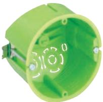
Hohlwand-Leuchtenanschlussdose, flammwidrig, für Plattenstärken von 0,5-33mm, mit M5-Messingbuchse zur Aufnahme eines Deckenhaken aus dem Zubehörprogramm, max. Belastung des Hakens 20 N nach DIN VDE 0100
