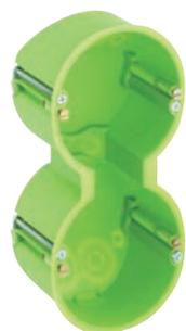
Hohlwand-Gerätedoppeldose, flammwidrig, für Plattenstärken von 1 bis 40 mm, mit angespritzten, patentierten Kombibrücken und Lochwerkzeug, Geräteschraubenabstand 60 mm
