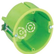
Hohlwand-Verbindungsdose, flammwidrig, für Plattenstärken von 1 bis 30 mm, Geräteschraubenabstand 67 mm
