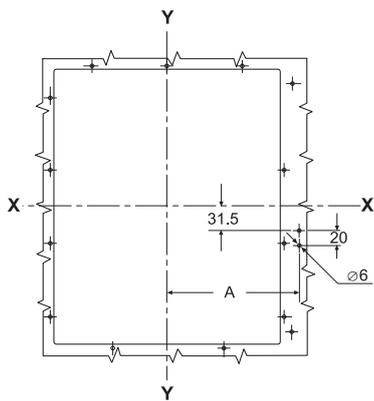
Минимальное расстояние между автоматическим выключателем и стенкой распределительного щита
