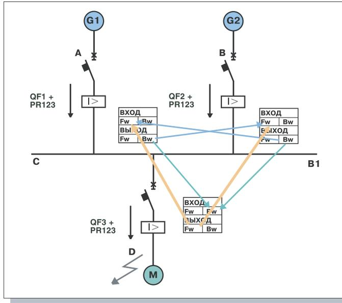
В следующем примере приведен анализ сети с секционником и рассматривается режим работы устройств защиты в случае короткого замыкания:
