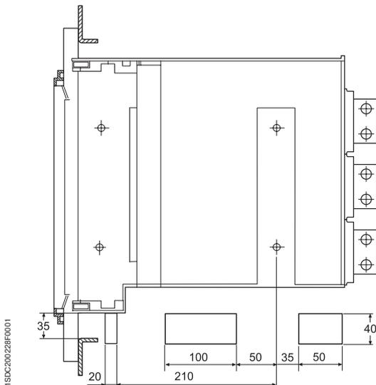
Момент затяжки для крепежных винтов - 20 Нм
