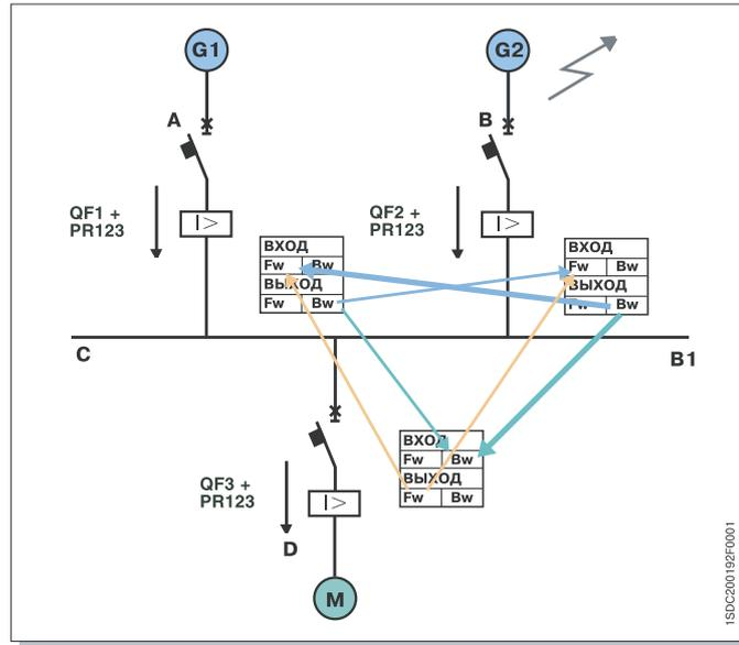
3) При коротком замыкании в точке С через автоматические выключатели QF1 и QF2 протекает ток, совпадающий по направлению с установленным, в то время как через QF3 течет ток в обратном направлении. Ни один из автоматических выключателей не "блокируется" и, следовательно, все автоматические выключатели, которые затрагивает короткое замыкание, срабатывают в соответствии с установленными временами срабатывания защиты S и/или I.
