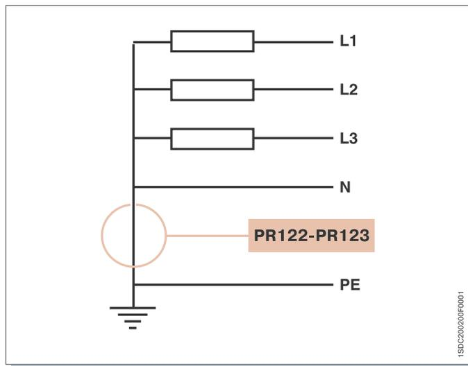
Использование этого аксессуара обеспечивает защиту от замыкания на землю (функция G) независимо от типоразмера первичных трансформаторов тока, установленных на фазах автоматического выключателя. Технические характеристики тороида приведены в таблице на стр. 6/24.
