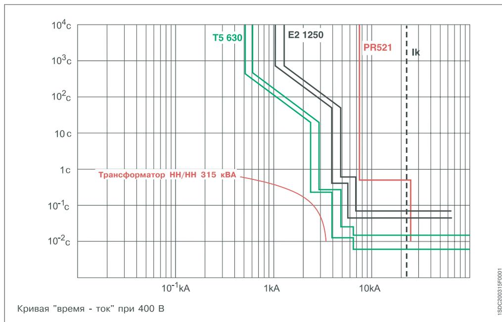
**Автоматический выключатель CH (PR521)**
