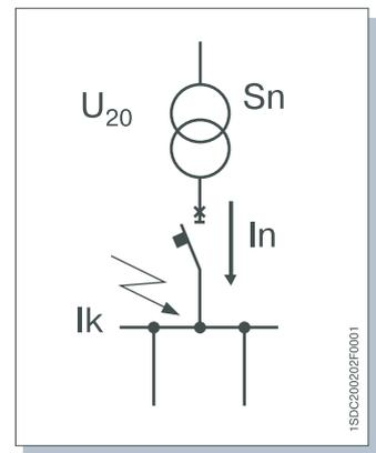
Ток трехфазного короткого замыкания при полном напряжении непосредственно на выводах НН трансформатора можно рассчитать по следующей формуле (принимая мощность короткого замыкания на первичной обмотке бесконечной):
