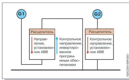
На рисунке выше показана фактическая конфигурация автоматических выключателей в системе. Стрелкой красного цвета указано контрольное направление, установленное на автоматическом выключателе по умолчанию.
