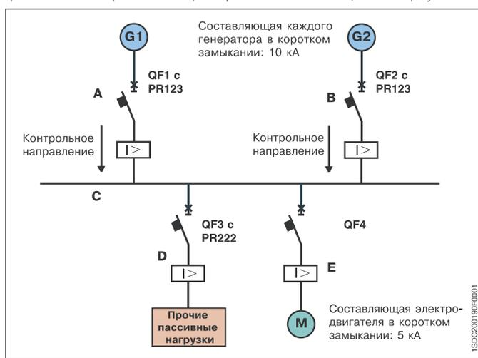
На следующей электрической схеме контрольные направления показаны черным цветом. При анализе конфигурации автоматических выключателей, установленных в соответствии со схемой, приведенной выше, можно заметить, что для QF2 такое направление используется по умолчанию, в то время как для QF1 направление было инвертировано при помощи программного обеспечения.
