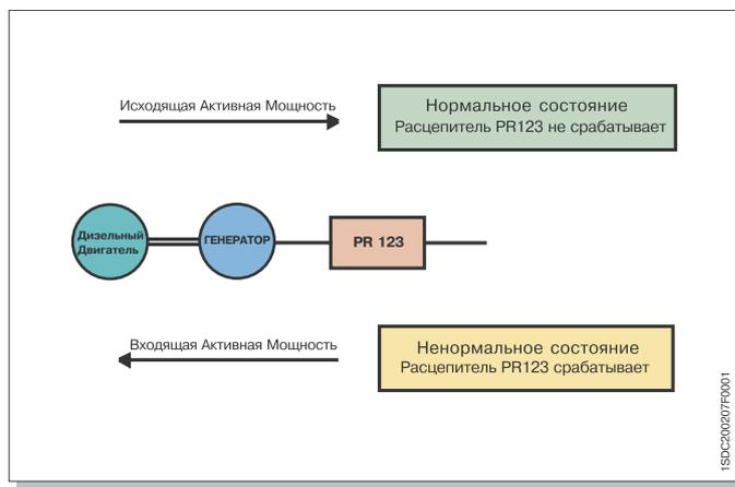
При падении мощности, измеренной расцепителем, ниже нуля срабатывает расцепитель PR123, отключая автоматический выключатель и, следовательно, предотвращая возможные повреждения.
