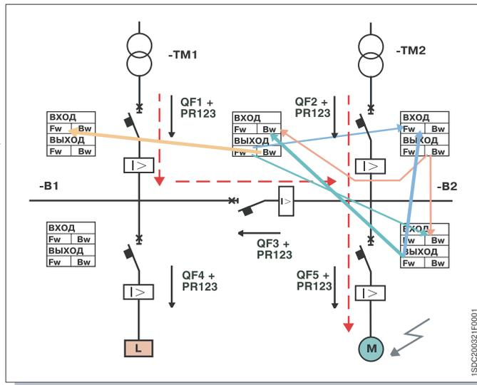
3) Короткое замыкание на стороне питания трансформатора ТМ2: в данном случае прерывание тока короткого замыкания должно осуществляться только автоматическим выключателем QF2. Через автоматический выключатель QF2 проходит ток от трансформатора ТМ1 и электродвигателя в направлении, не совпадающем с установленным, в результате чего шина OUT Bw автоматического выключателя QF2 "блокирует":
