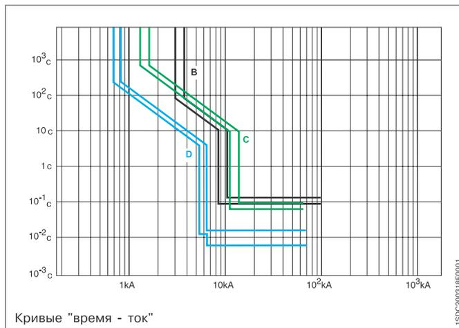
На последнем рисунке показана возможность переключения на набор уставок, гарантирующих селективность автоматических выключателей С с выключателем В с помощью функции двойных настроек.
