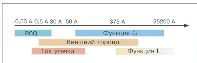
На данном рисунке показано, какую функцию электронного расцепителя или устройство следует применять в зависимости от величины тока замыкания на землю.
