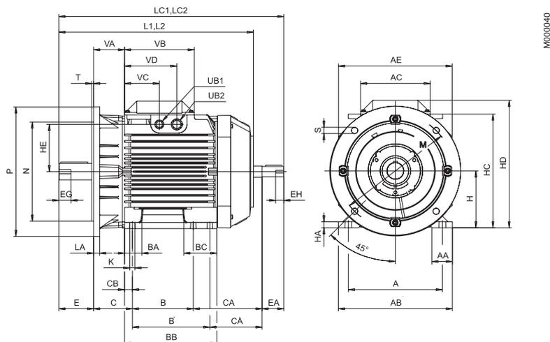
Электродвигатель промышленного назначения с монтажом на лапах и фланце;
