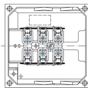
Соединительная коробка для типоразмеров двигателя 90–100
