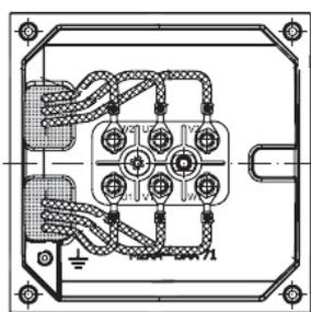
Соединительная коробка для типоразмеров двигателя 71–80
