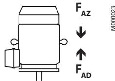
Схема монтажа IM V1
