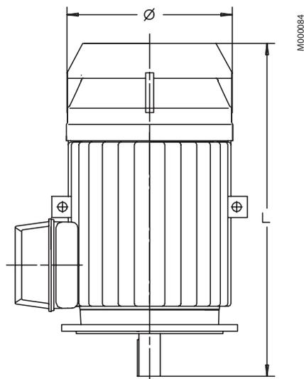
Схема монтажа IM V1 с защитным кожухом
