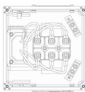
Соединительная коробка для типоразмеров двигателя 200–280
