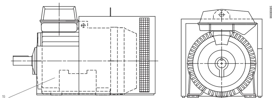
Электродвигатели обоих типов монтажа - как на лапах, так и на фланце - могут быть оснащены шумопоглотителем для снижения уровня шума примерно на 10 дБ(А). Шумопоглотитель покрыт краской синего цвета и изготовлен из листовой стали 2 мм. Шумопоглощающий материал — пенополиуретан толщиной 40 мм. На нижней стороне имеется резиновая прокладка для герметичного уплотнения относительно основания. Шумопоглотитель свободно устанавливается на электродвигатель.
