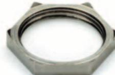
Для крепления латунных кабельных вводов и пробок-заглушек гайка снабжена шестью зубцами, которые обеспечивают контакт контргайки с корпусом во время затяжки.
