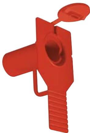
Для монтажа в предварительно изготовленных стенах или потолке используется переходник прямой формы. Требуемый размер для края опалубки можно точно установить и зафиксировать с помощью встроенной измерительной планки с шагом 5 мм.
