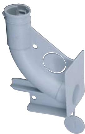
90-градусное колено этого переходника значительно облегчает последующее подведение проводов. Две сформированные поверхности обеспечивают крепление термоклеем и на опалубке, и на краю опалубки. Так просто создаются целостные подводы труб и выпуски для стены и потолка.
