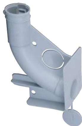
90-градусное колено этого переходника облегчает последующую протяжку проводов. Обе плоские поверхности приклеиваются к опалубке термоклеем. Так просто создаются целостные подводы труб и потолочные и настенные выпуски.
