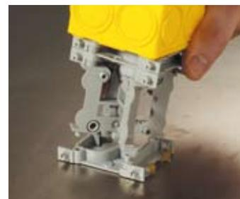
**Контропора** требуется для расположенных сверху коробок в качестве начального элемента на опалубке. Контропора доступна в исполнении с клеем или без него и может комбинироваться со всеми удлинителями и ответвительными коробками.
