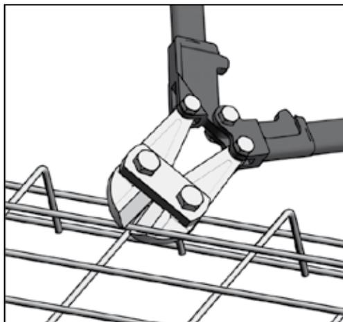
Форма проволочного лотка может быть изменена в соответствии с вашими требованиями. Для удаления частей металлической сетки мы рекомендуем использовать профессиональный набор инструмента с односторонней режущей кромкой (как показано на рисунке). Для того чтобы предотвратить возможное повреждение кабеля, следует обрезать проволоку по возможности ближе к узлам пересечения.
