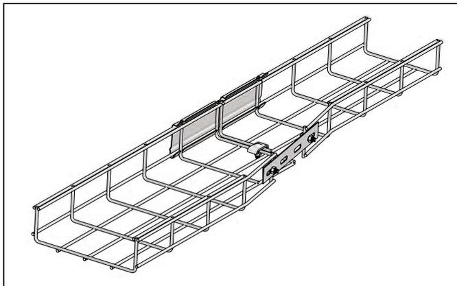
Для соединения с секцией меньшего размера ширина проволочного лотка может быть уменьшена. Все операции состоят из нескольких простых этапов, позволяющих получить необходимый результат.
