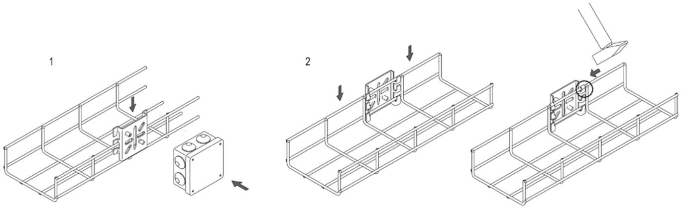
Для крепления разветвительных коробок и монтажа на стену.
