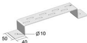
Используется в качестве напольного, стенового и подвесного кронштейна.
