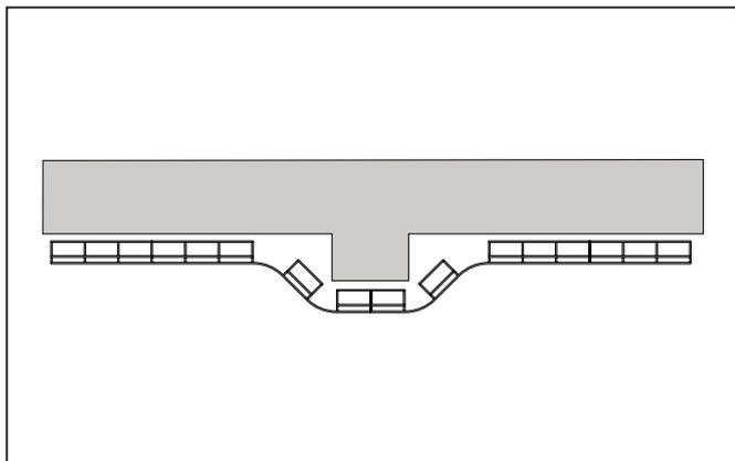
Можно обеспечить прокладку лотков на любых уровнях путем удаления соответствующих зон лотка и его сгибания до нужных размеров. Высокая прочность конструкции достигается при использовании соединительных элементов V 35\*200.
