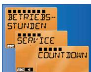
➤ Встроенный счетчик часов работы, а также, счетчик с обратным отсчетом с выходом для сигнализации окончания срока эксплуатации ламп (для всех каналов)
