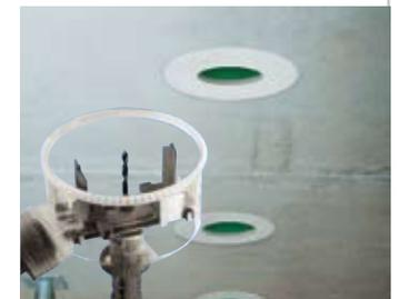
Универсальная фреза VARIOCUT позволяет прорезать точные монтажные отверстия различных диаметров в минераловатных фронтальных элементах.
