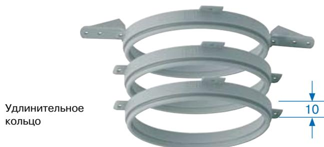
Для плит толщиной более 50 мм корпус можно удлинять с помощью удлинительного кольца 1290-14 с шагом 10 мм.
