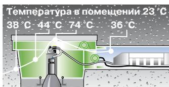
50 Вт, QR-CBC 51 (охлаждающий блок Cool-Beam с предохранительной шайбой).
