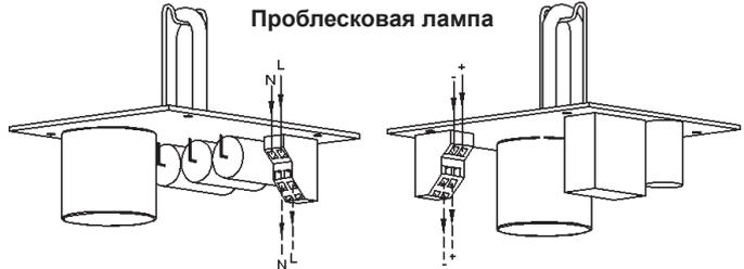
для последовательного подключения дополнительных устройств
