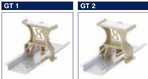
Держатели групп шильдиков GT 1 и GT 2 устанавливаются непосредственно на рейку TS 32 или 35. Держатель GT 1 маркируется с помощью вставного шильдика ESO GT 1 и защитной полоски STR GT 1. Держатель GT 2 маркируется с помощью ESO GT 2 и защитной полоски STR GT 2 или самоклеющейся этикетки GKE 30/6.
