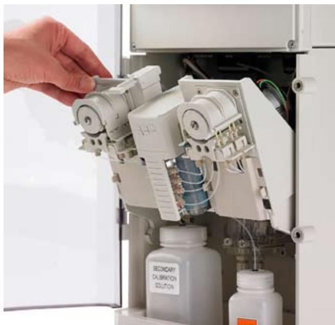
Модуль подготовки пробы
