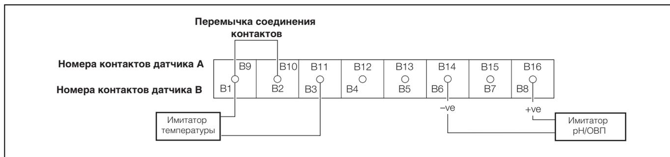
Рис. 7.1 Присоединение переключек контактов анализатора и декадного магазина сопротивлений
