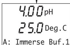
**Калибровка с использованием буферного раствора (калибровка по одной точке) или калибровка с использованием буферного раствора 1 (калибровка по двум точкам)**
