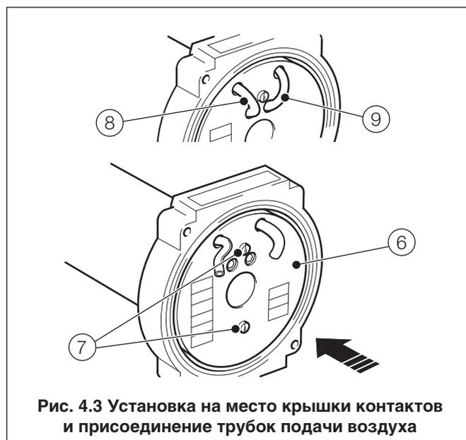
**Рис. 4.3 Установка на место крышки контактов и присоединение трубок подачи воздуха**
