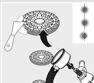
Fluchtlinie anzeichnen und gewünschte Einbauöffnung in die Platte schneiden.
