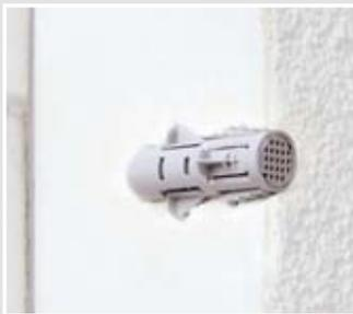
Durch das Eindrücken des Befestigungskerns werden die Schwenkschneiden in dem Dämmmaterial verankert und geben dem Mini-Geräteträger sicheren Halt.
