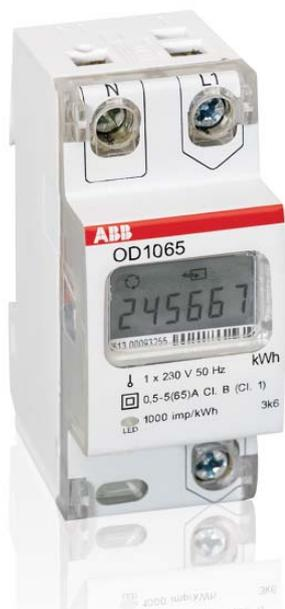
ODINsingle представляет собой компактный однофазный счетчик. Счетчик предназначен для монтажа на DIN-рейку, и пригоден для установки в распределительных щитах и небольших боксах. Счетчик поставляется в двух исполнениях: базовая версия, а также версия с импульсным выходом и дополнительным обнуляемым регистром.
