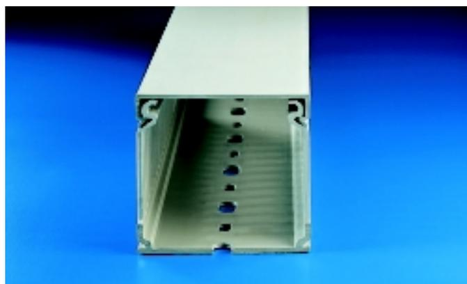
Были также разработаны новые кабель каналы стандартного сечения 50 x 50 мм и 100 x 60 мм с круглыми выдавливаемыми отверстиями на боковых стенках, которые предназначены для выполнения отводов в виде жестких и гофрированных изоляционных труб в тех местах, где это необходимо, например, в шахтах лифта.
