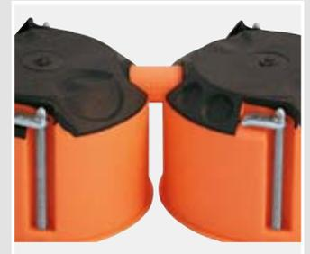
Für die luftdichte Kombination der Hohlwanddosen sorgt der Verbindungsstutzen, der werkzeuglos über die abziehbaren Laschen eingefñhrt wird.
