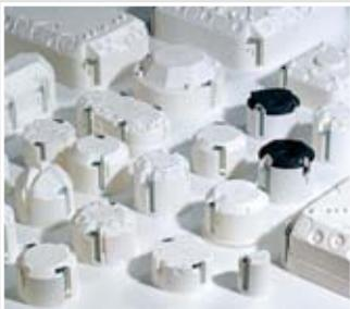
Bei den Hohlwanddosen und -kästen, welche mit einem VDE-Zeichen gekennzeichnet sind, wird die Feuerbeständigkeit durch eine Glühdrahtprüfung mit 850°C getestet (gemäß VDE 0471 / DIN EN 60695-2-11). Dabei muss nachgewiesen werden, dass im Fall einer fehlerhaften Elektro-Installation kein Brand durch die Hohlwanddosen ausgelöst wird. Unabhängig davon sind die einschlägigen Brandschutzmaßnahmen der Wandkonstruktion einzuhalten.
