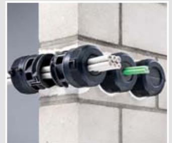
Waagerechte oder senkrechte Anordnung von bis zu drei Dosenschotts mit einem Mittenabstand von 91 mm ist zulässig.
