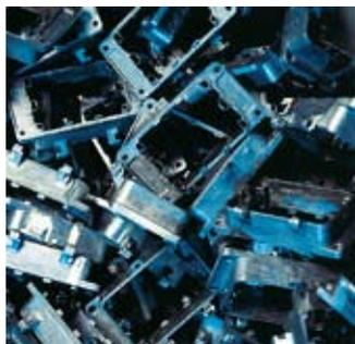
Алюминиевые корпуса, изготовленные литьем под давлением
