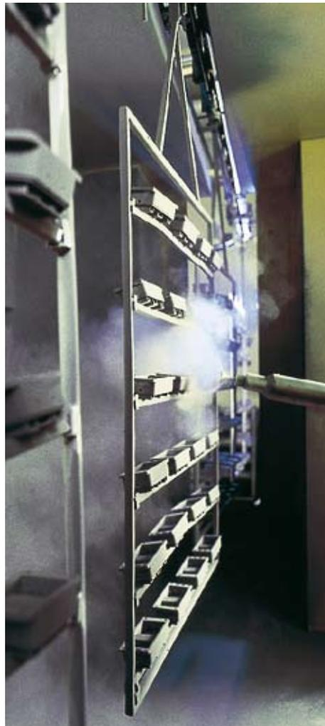
Установка для порошкового покрытия
