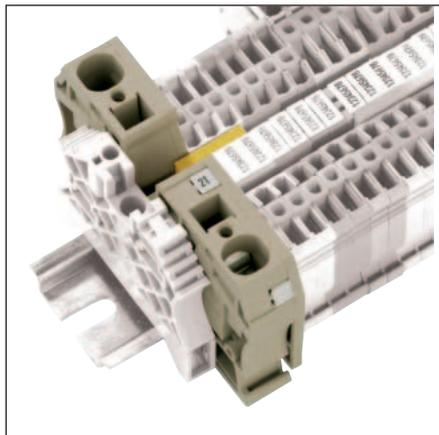
Клеммы Weidmüller IDC2 поставляются с входными клеммами ZEI 16. Штекерные мостики распределяют входной ток на несколько выходов. Подача тока осуществляется проводником сечением 16 мм<sup>2</sup> и затем распределяется между соседними клеммами для сечений 1,5 мм<sup>2</sup> и 2,5 мм<sup>2</sup>.
