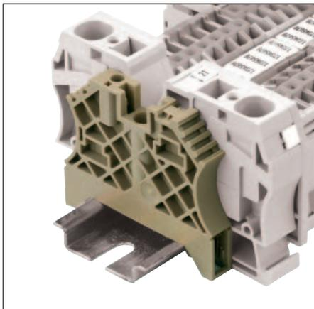
Концевой стопор устанавливается на монтажной рейке справа и слева от клемм для обеспечения их надежного крепления. Маркировочный шильдик концевого стопора может также использоваться для групповой маркировки.
