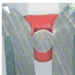
Проводник подключен - изоляция полностью прорезана, обеспечив надежный контакт на широкой поверхности
