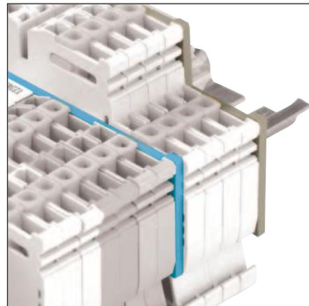
Концевые пластины и разделяющие перегородки обеспечивают защиту от прикосновения и поражения электрическим током. Дополнительно, для повышения наглядности монтажа применяются разноцветные концевые пластины и разделительные перегородки, хорошо заметные и отчетливо разделяющие клеммный ряд.
