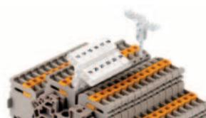
Этот носитель на пластине специально спроектирован для двухуровневых клемм IDK 1,5N I ряда. Гибкий шарнирный механизм обеспечивает легкость подключения или отключения штекерных мостиков. Он может быть снабжен четырьмя шильдиками DEK 5 или двумя WS 10/5
