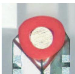
Проводник подключается - изоляция прорезана, обеспечив начальный контакт с шиной
