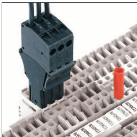
Тестовый адаптер (ТА) используется как обычный элемент и как шина тестового адаптера для проведения измерений в распределительном шкафу. Тестовый адаптер позволяет комфортно производить проверку клеммных сборок путем простого защелкивания в клемме. Таким образом создается контакт с токоведущей шиной. Устройство отключается от клеммы путем простого нажатия освобождающей кнопки.
