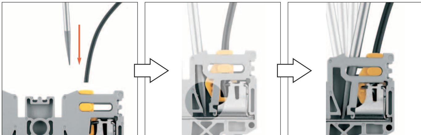
Вставьте конец провода в клемму
