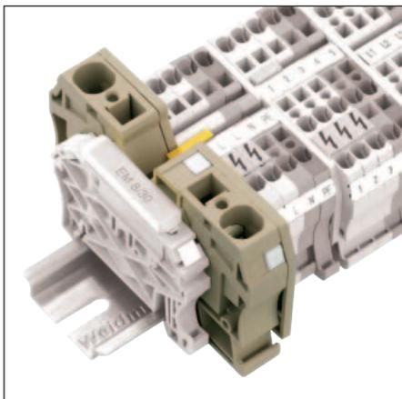
Клемма питания ZEI16 позволяет подключать проводники сечением до 25 мм<sup>2</sup>. Затем напряжение с помощью штекерных мостиков распределяется на несколько клемм с меньшими сечениями.
