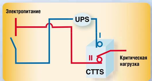
Переключатели без разрыва тока (CTTS) разработан концерном АББ. ОЕСС обеспечивают гарантированное ручное переключение с основной линии на резервную, и обратно без перерыва в подаче питания. Это гарантирует постоянную подачу питания на оборудование, даже при проведении на нем ремонтно-профилактических работ.
