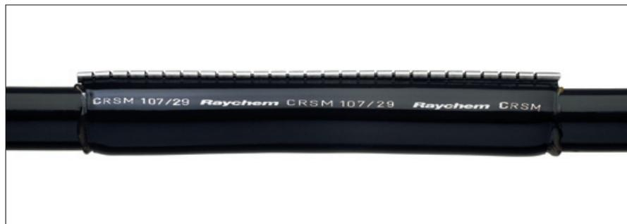
Галогено-чистые ремонтные оборачиваемые манжеты CRSM предназначены для быстрого и надежного ремонта поврежденных пластмассовых или металлических оболочек кабелей и восстанавливают электрическую и механическую целостность кабеля. На внутренней поверхности манжет нанесен термоплавкий клей.
