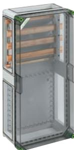
Sammelschienegehäuse - Industrie Qualität -, 5-polig, 630 A, mit Cu-Schienen, L1...L3: 30 x 10 mm, N: 25 x 10 mm, PE: 12 x 10 mm, ohne Klemmen, zur individuellen Bestückung, 4 x Gehäuseverbinder (GGV)
