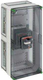
Leistungsschaltergehäuse - Industrie Qualität - mit externer Betätigung, abschließbar, 1 x Leistungsschalter 630 A, 3-polig schaltend, Auslösebereich 320-630 A, Schraubanschluss M10, PE/N-Klemme M12, 4 x Gehäuseverbinder (GGV)
