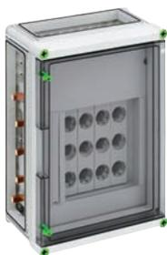
DIAZED<sup>®</sup>-Reiter-Sicherungsgehäuse mit zusätzlichem Anschlussraum - Industrie Qualität -, 8 x 3-polige DII-Reiter-Sicherungssockel, E 27-Gewinde, Bemessungsstrom 25 A, Schraubanschluss 1,5 - 25 mm<sup>2</sup>, auf Sa-Schiene 5-polig, N-Klemmen 1,5 - 16 mm<sup>2</sup>, PE-Klemmen 1,5 - 16 mm<sup>2</sup>, 3 x Gehäuseverbinder (GGV)
