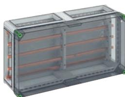
Sammelschienegehäuse - Industrie Qualität -, 5-polig, 250 A, mit Cu-Schienen, L1...L3: 12 x 10 mm, N: 12 x 10 mm, PE: 12 x 10 mm, ohne Klemmen, zur individuellen Bestückung, 4 x Gehäuseverbinder (GGV)
