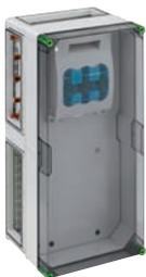
NH-Reiter-Sicherungs-Lasttrennschaltergehäuse - Industrie Qualität - 1 x NH 1-Reiter-Sicherungs-Lasttrennschalter, Bemessungsstrom 250 A, Schraubanschluss M10, Abgang unten, auf Sa-Schiene 5-polig, N-Klemme 16 - 120 mm<sup>2</sup>, PE-Klemme 16 - 120 mm<sup>2</sup>, 4 x Gehäuseverbinder (GGV)
