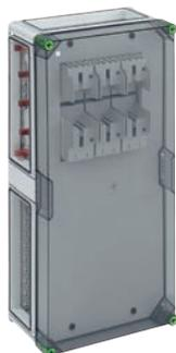
NH-Reiter-Sicherungsgehäuse - Industrie Qualität - , 1 x NH 1-Reiter-Sicherungsunterteil, Bemessungsstrom 250 A, Schraubanschluss M10, Abgang unten, auf Sa-Schiene 5-polig, N-Klemme 16 - 120 mm<sup>2</sup>, PE-Klemme 16 - 120 mm<sup>2</sup>, 4 x Gehäuseverbinder (GGV)
