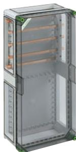
Sammelschienegehäuse - Industrie Qualität -, 5-polig, 250 A, mit Cu-Schienen, L1...L3: 12 x 10 mm, N: 12 x 10 mm, PE: 12 x 10 mm, ohne Klemmen, zur individuellen Bestückung, 4 x Gehäuseverbinder (GGV)
