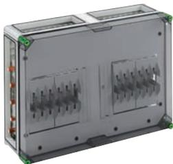
NH-Reiter-Sicherungsgehäuse mit zusätzlichem Anschlussraum - Industrie Qualität - 4 x NH 00-Reiter-Sicherungsunterteil, Bemessungsstrom 125 A, Schellenanschluss 1,5 - 70 mm<sup>2</sup>, Abgang unten, auf Sa-Schiene 5-polig, N-Klemmen 4 - 35 mm<sup>2</sup>, PE-Klemmen 4 - 35 mm<sup>2</sup>, 4 x Gehäuseverbinder (GGV)
