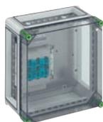
NH-Sicherungs-Lasttrennschaltergehäuse -Industrie Qualität- montiert auf Montageplatte, 1 x NH 00-Sicherungs-Lasttrennschalter, Bemessungsstrom 125 A, Schellenanschluss 1,5 - 70 mm<sup>2</sup>, PE/N-Klemme 2 x 50 mm<sup>2</sup>, 3 x Gehäuseverbinder (GGV)
