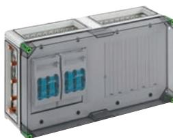
NH-Reiter-Sicherungs-Lasttrennschaltergehäuse - Industrie Qualität - 2 x NH 00-Reiter-Sicherungs-Lasttrennschalter, Bemessungsstrom 125 A, Schellenanschluss 1,5 - 70 mm<sup>2</sup>, Abgang universal, auf Sa-Schiene 5-polig, mit 5 Sammelschienenklemmen 16 - 70 mm<sup>2</sup>, N-Klemmen 4 - 35 mm<sup>2</sup>, PE-Klemmen 4 - 35 mm<sup>2</sup>, 4 x Gehäuseverbinder (GGV)
