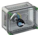
Lasttrennschaltergehäuse - Industrie Qualität - mit externer Betätigung, abschließbar, 1 x Lasttrennschalter 80A, 3-polig schaltend, Käfigklemme 2,5 - 35 mm<sup>2</sup>, PE/N-Klemme 35 mm<sup>2</sup>, 3 x Gehäuseverbinder (GGV)
