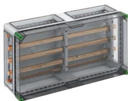
Sammelschienegehäuse - Industrie Qualität -, 5-polig, 630 A, mit Cu-Schienen, L1...L3: 30 x 10 mm, N: 25 x 10 mm, PE: 12 x 10 mm, ohne Klemmen, zur individuellen Bestückung, 4 x Gehäuseverbinder (GGV)
