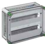
Automatengehäuse - Industrie Qualität - , 40 Teilungseinheiten, 2-reihig,  $U_i=400V$ , PE/N-Klemme 2 x 12-polig 6-16 mm<sup>2</sup>, Abdeck- und Beschriftungsstreifen, 3 x Gehäuseverbinder (GGV)
