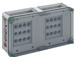
DIAZED®-Reiter-Sicherungsgehäuse - Industrie Qualität - 8 x 3-polige DII-Reiter-Sicherungssockel, E 27-Gewinde, Bemessungsstrom 25 A, Schraubanschluss 1,5 - 25 mm<sup>2</sup>, auf Sa-Schiene 5-polig, N-Klemmen 1,5 - 16 mm<sup>2</sup>, PE-Klemmen 1,5 - 16 mm<sup>2</sup>, 4 x Gehäuseverbinder (GGV)
