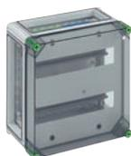
Automatengehäuse - Industrie Qualität - , 28 Teilungseinheiten, 2-reihig,  $U_i=400V$ , PE/N-Klemme 2 x 12-polig 6-16 mm<sup>2</sup>, Abdeck- und Beschriftungsstreifen, 3 x Gehäuseverbinder (GGV)
