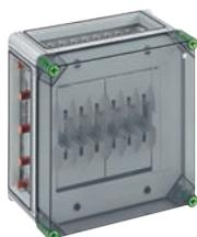
NH-Reiter-Sicherungsgehäuse - Industrie Qualität - , 2 x NH 00-Reiter-Sicherungsunterteil, Bemessungsstrom 100 A, Schellenanschluss 1,5 - 70 mm<sup>2</sup>, Abgang oben, auf Sa-Schiene 5-polig, N-Klemmen 4 - 35 mm<sup>2</sup>, PE-Klemmen 4 - 35 mm<sup>2</sup>, 3 x Gehäuseverbinder (GGV)
