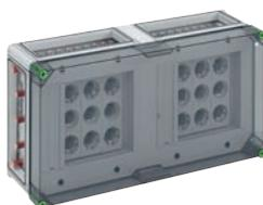
DIAZED®-Reiter-Sicherungsgehäuse - Industrie Qualität - 6 x 3-polige DIII-Reiter-Sicherungssockel, E 33-Gewinde, Bemessungsstrom 63 A, Schraubanschluss 1,5 - 25 mm<sup>2</sup>, auf Sa-Schiene 5-polig, mit 5 Sammelschienenklemmen 4 - 35 mm<sup>2</sup>, N-Klemmen 1,5 - 16 mm<sup>2</sup>, PE-Klemmen 1,5 - 16 mm<sup>2</sup>, 4 x Gehäuseverbinder (GGV)
