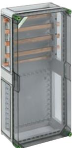
Sammelschienegehäuse - Industrie Qualität -, 5-polig, 400 A, mit Cu-Schienen, L1...L3: 20 x 10 mm, N: 20 x 10 mm, PE: 12 x 10 mm, ohne Klemmen, zur individuellen Bestückung, 4 x Gehäuseverbinder (GGV)
