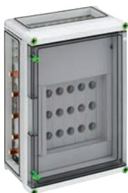
NEOZED<sup>®</sup>-Reiter-Sicherungsgehäuse mit zusätzlichem Anschlussraum - **Industrie Qualität**, 5 x 3-polige D02-Reiter-Sicherungssockel, E 18-Gewinde, Bemessungsstrom 63 A, Schraubanschluss 1,5 - 25 mm<sup>2</sup>, auf Sa-Schiene 5-polig, mit 5 Sammelschienenklemmen 16 - 70 mm<sup>2</sup>, N-Klemmen 1,5 - 16 mm<sup>2</sup>, PE-Klemmen 1,5 - 16 mm<sup>2</sup>, 3 x Gehäuseverbinder (GGV)
