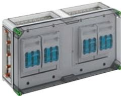
NH-Reiter-Sicherungs-Lasttrennschaltergehäuse - Industrie Qualität - 4 x NH 00-Reiter-Sicherungs-Lasttrennschalter, Bemessungsstrom 125 A, Schellenanschluss 1,5 - 70 mm<sup>2</sup>, Abgang universal, auf Sa-Schiene 5-polig, N-Klemmen 4 - 35 mm<sup>2</sup>, PE-Klemmen 4 - 35 mm<sup>2</sup>, 4 x Gehäuseverbinder (GGV)
