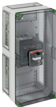
Leistungsschaltergehäuse - Industrie Qualität - mit externer Betätigung, abschließbar, 1 x Leistungsschalter 250 A, 3-polig schaltend, Auslösbereich 63-250 A, Schraubanschluss M8, PE/N-Klemme M10, 4 x Gehäuseverbinder (GGV)
