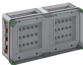
NEOZED®-Reiter-Sicherungsgehäuse - Industrie Qualität - 10 x 3-polige D02-Reiter-Sicherungssockel, E 18-Gewinde, Bemessungsstrom 63 A, Schraubanschluss 1,5 - 25 mm<sup>2</sup>, auf Sa-Schiene 5-polig, mit 5 Sammelschienenklemmen 4 - 35 mm<sup>2</sup>, N-Klemmen 1,5 - 16 mm<sup>2</sup>, PE-Klemmen 1,5 - 16 mm<sup>2</sup>, 4 x Gehäuseverbinder (GGV)
