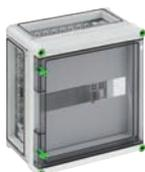
Automatengehäuse - Industrie Qualität - , 14 Teilungseinheiten, 1-reihig,  $U_i=400V$ , serienmäßig plombierbar, mit 35 mm Normschiene zum Einbau eines selektiven Hauptschalters, inkl. 2 einpoligen HA-Klemmen 25/16 mm<sup>2</sup> für N und PE, Abdeck- und Beschriftungsstreifen, 3 x Gehäuseverbinder (GGV)
