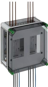
Zählergehäuse - Industrie Qualität - mit 2 montierten BKE-I für elektronische Haushaltszähler, inkl. Anschlussleitungen für Zu- und Abgang 1000 mm, mit Plombierset, mit Befestigungsschrauben, 3 x Gehäuseverbinder (GGV)
