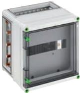
Automatengehäuse - Industrie Qualität - , 14 Teilungseinheiten, 1-reihig, serienmäßig plombierbar, mit Sammelschienensystem 5-polig 250A, Sammelschieneinspeisung 70/35 mm<sup>2</sup> und Adapter zum Einbau eines selektiven Hauptschalters, Abdeck- und Beschriftungsstreifen, 3 x Gehäuseverbinder (GGV)
