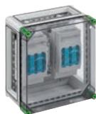
NH-Sicherungs-Lasttrennschaltergehäuse -Industrie Qualität- montiert auf Montageplatte, 2 x NH 00-Sicherungs-Lasttrennschalter, Bemessungsstrom 100 A, Schellenanschluss 1,5 - 70 mm<sup>2</sup>, PE/N-Klemme 2 x 50 mm<sup>2</sup>, 3 x Gehäuseverbinder (GGV)
