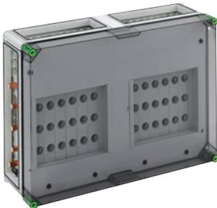
NEOZED®-Reiter-Sicherungsgehäuse mit zusätzlichem Anschlussraum - Industrie Qualität, 12 x 3-polige D02-Reiter-Sicherungssockel, E 18-Gewinde, Bemessungsstrom 63 A, Schraubanschluss 1,5 - 25 mm<sup>2</sup>, auf Sa-Schiene 5-polig, mit 5 Sammelschienenklemmen 16 - 70 mm<sup>2</sup>, N-Klemmen 1,5 - 16 mm<sup>2</sup>, PE-Klemmen 1,5 - 16 mm<sup>2</sup>, 4 x Gehäuseverbinder (GGV)
