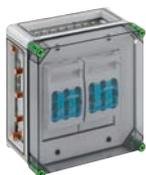
NH-Reiter-Sicherungs-Lasttrennschaltergehäuse - Industrie Qualität - 2 x NH 00-Reiter-Sicherungs-Lasttrennschalter, Bemessungsstrom 125 A, Schellenanschluss 1,5 - 70 mm<sup>2</sup>, Abgang universal, auf Sa-Schiene 5-polig, N-Klemmen 4 - 35 mm<sup>2</sup>, PE-Klemmen 4 - 35 mm<sup>2</sup>, 3 x Gehäuseverbinder (GGV)
