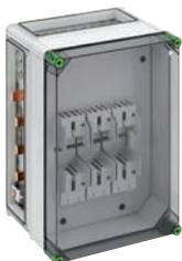
NH-Reiter-Sicherungsgehäuse mit zusätzlichem Anschlussraum - Industrie Qualität - 1 x NH 1-Reiter-Sicherungsunterteil, Bemessungsstrom 250 A, Schraubanschluss M10, Abgang unten, auf Sa-Schiene 5-polig, N-Klemme 4 - 35 mm<sup>2</sup>, PE-Klemme 4 - 35 mm<sup>2</sup>, 4 x Gehäuseverbinder (GGV)
