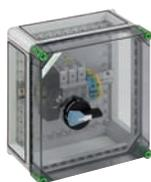
Lasttrennschaltergehäuse - Industrie Qualität - mit externer Betätigung, abschließbar, 1 x Lasttrennschalter 100A, 3-polig schaltend, Käfigklemme 2,5 - 35 mm<sup>2</sup>, PE/N-Klemme 35 mm<sup>2</sup>, 3 x Gehäuseverbinder (GGV)
