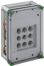
DIAZED®-Reiter-Sicherungsgehäuse mit zusätzlichem Anschlussraum - Industrie Qualität -, 3 x 3-polige DIII-Reiter-Sicherungssockel, E 33-Gewinde, Bemessungsstrom 63 A, Schraubanschluss 1,5 - 25 mm<sup>2</sup>, auf Sa-Schiene 5-polig, mit 5 Sammelschienenklemmen 16 - 70 mm<sup>2</sup>, N-Klemmen 1,5 - 16 mm<sup>2</sup>, PE-Klemmen 1,5 - 16 mm<sup>2</sup>, 3 x Gehäuseverbinder (GGV)
