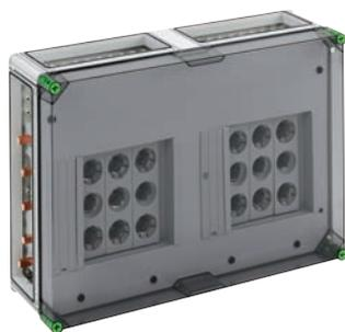
DIAZED®-Reiter-Sicherungsgehäuse mit zusätzlichem Anschlussraum - Industrie Qualität -, 6 x 3-polige DIII-Reiter-Sicherungssockel, E 33-Gewinde, Bemessungsstrom 63 A, auf Sa-Schiene 5-polig, mit 5 Sammelschienenklemmen 16 - 70 mm<sup>2</sup>, N-Klemmen 1,5 - 16 mm<sup>2</sup>, PE-Klemmen 1,5 - 16 mm<sup>2</sup>, 4 x Gehäuseverbinder (GGV)
