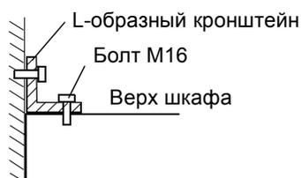
Крепление шкафа сверху с использованием L-образных кронштейнов (вид сбоку)
