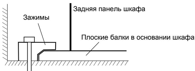
Крепление шкафа к полу с задней стороны с помощью зажимов
